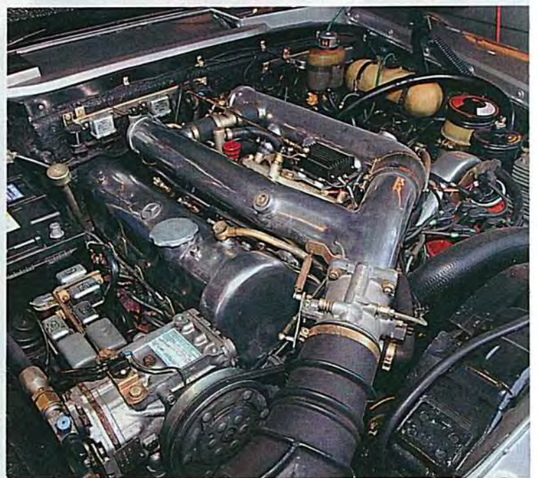
Gewohntes Bild: Benzominos serienmäßiger Maschinenraum. Einzige Änderung: die Blackbox der Elektronik-Zündung auf dem Motor
